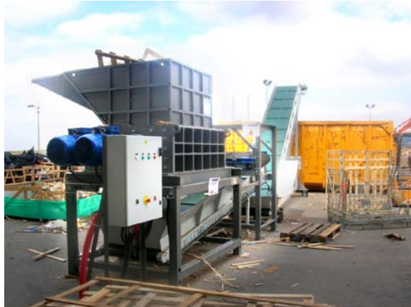
Broyage de palettes sur BLiK B840: l'ensemble de l'installation
