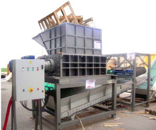
Broyage de palettes sur BLiK B840: le broyeur
