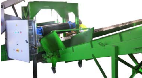
Convoyeur d'alimentation, Broyeur B840, tri magnétique par overband, convoyeur d'évacuation
