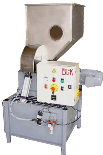
Broyeur BLiK BB230 avec fouloir pneumatique: bouteilles plastiques: rendement 500- 600 par heure
