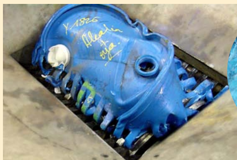
Broyage de fûts plastiques sur Broyeur BLIK B600
