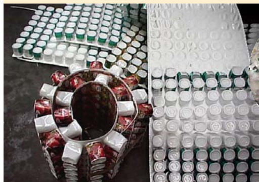
Agroalimentaire: broyage de plastique formé (ici pots de yaourts) sur broyeur BLIK: volume divisé par 10
