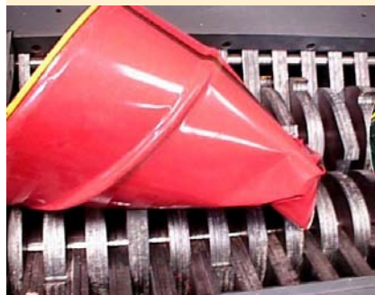
Broyage de fûts métalliques sur Broyeur BLIK B600
