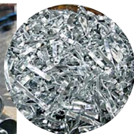
Broyage de tubes galvanisés sur broyeur BLIK (importante réduction de volume, valorisation)
