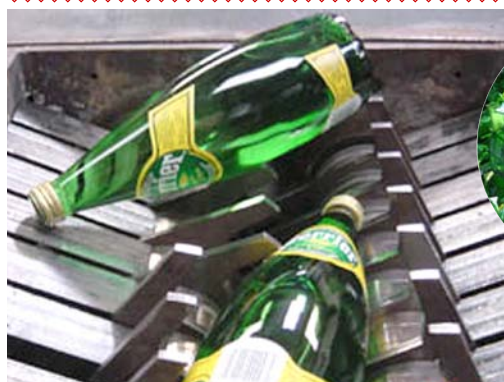
Broyage de bouteilles verre sur broyeur BLIK B400 équipé de couteaux brise-verre
