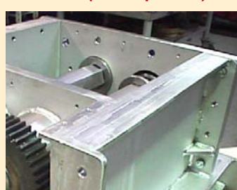
inox: bloc de coupe couteaux non montés
