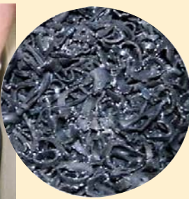
Broyage de durites sur broyeur BLIK (importante réduction de volume, valorisation)
