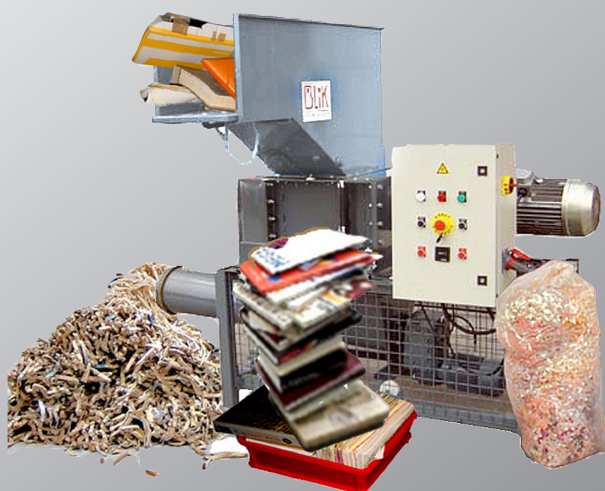
Broyeur BLIK B400 sortie vis sans fin
