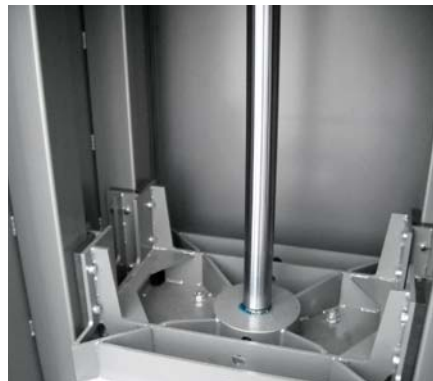
Plateau de compaction en fin de course; le plateau descend jusqu'au fond de la presse
