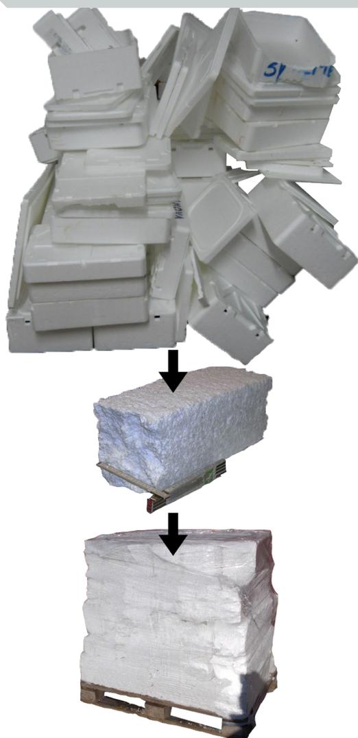
Le polystyrène expansé est déchiqueté dans un premier étage puis, dans un deuxième étage, compacté au moyen d'une vis et d'un canal de retenue.
