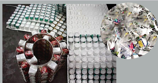
Agroalimentaire: broyage de plastique formé (ici pots de yaourts) sur broyeur BLIK : volume divisé par 10
