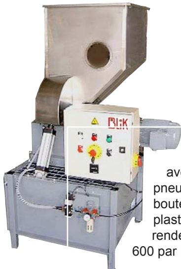
Broyeur BLiK BB160 destruction de tickets et cartes plastiques
