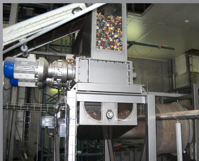
**B400-510** broyage de dosettes de café + séparation alu et café avec crible rotatif (trommel), avec rinçage
