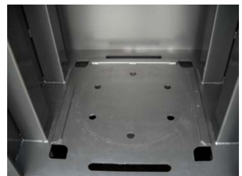
Piston relevé, fût retiré, liquide évacué et recueilli dans le bac de rétention Piston is raised, the barrel is withdrawn, the liquid is collected in the vat of retention
