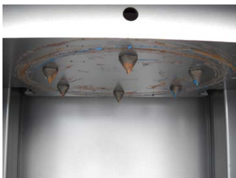
poinçons pour le maintien du fût et le vidage de l'air punches for the maintenance of the barrel and the emptying of the air
