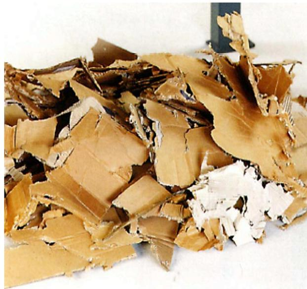
Les cartons sont fragmentés entre le rotor d'entraînement et le rotor déchiqueteur. Les déchets broyés peuvent ensuite tomber directement dans une presse ou être repris par un tapis d'évacuation
