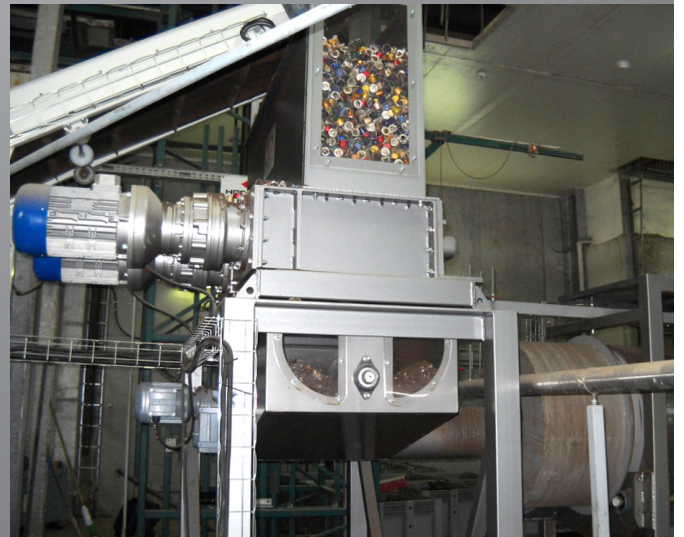
B400-510 broyage de dosettes de café + séparation alu et café avec crible rotatif (trommel), avec rinçage
