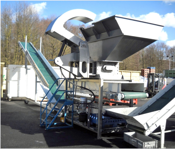
B600-510 + Q500 broyage de joints caoutchouc automobile
