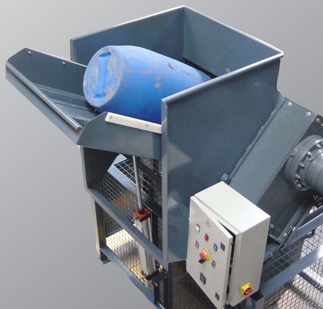
Broyeur BLIK B600: destruction de bidons plastiques: la seule manière de réduire leur volume, car en cas de simple compactage, ils reprennent peu à peu leur volume
