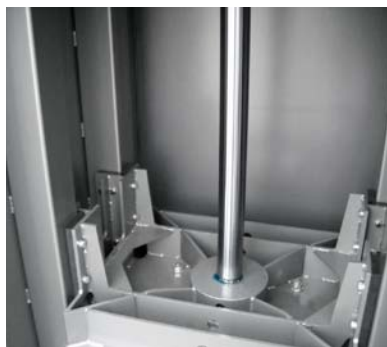
Plateau de compaction en fin de course; le plateau descend jusqu'au fond de la presse the piston goes down until the bottom
